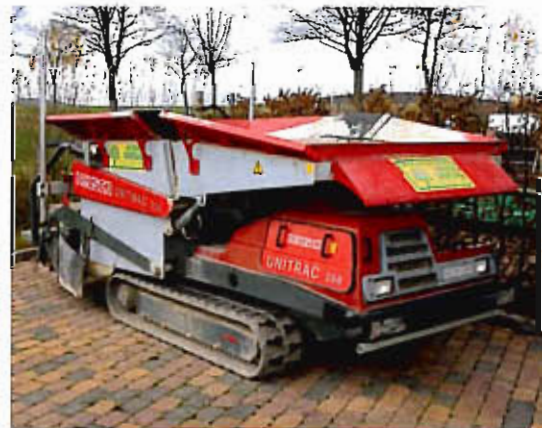
Zum Maschinenpark gehört auch dieser 2,5 t Neuson-Flächenfertiger auf Raupenfahwerk, der speziell für kleine Baumaßnahmen mit wechselnden Arbeitsbreiten konzipiert wurde.
