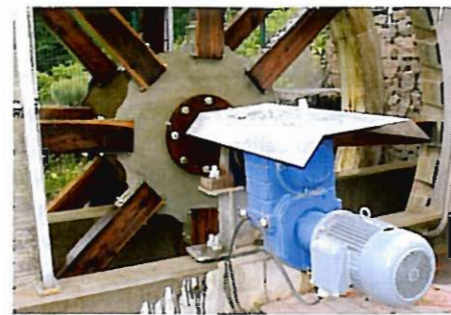
Ein Generator am Wasserrad sorgt für eine ausgeglichene Energiebilanz. Nachts oder wenn keine Badesaison ist, wird der Strom ins Netz eingespeist und kommt der Gemeinde zugute.
