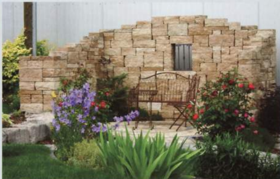
Alternative Wechselschichtmauer: Diese Mauer als Sitzschutz im Garten wurde mit vorgefertigten Steinen gebaut, die einfach geklebt werden – das reduziert die Kosten!
