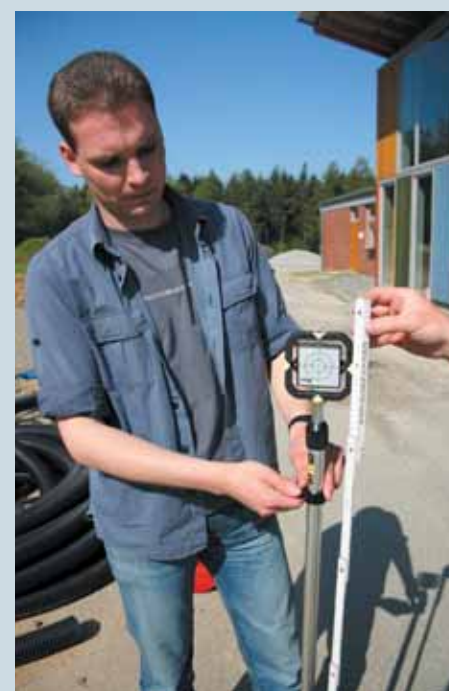
Die Länge der Prismenstange wird für die exakte Erfassung der Höhen in das Gerät eingegeben.
