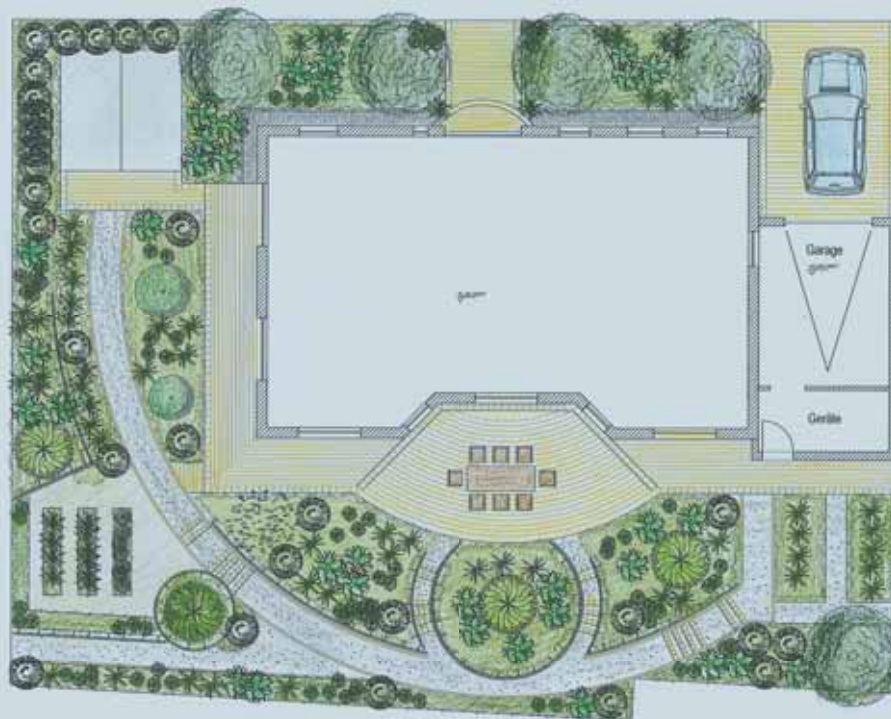
Privatgarten mit Totalstation aufgemessen, mit CAD geplant und mit der damit verknüpften Branchensoftware von DATAflor abgerechnet. | Planung: Peter Reintjes.
