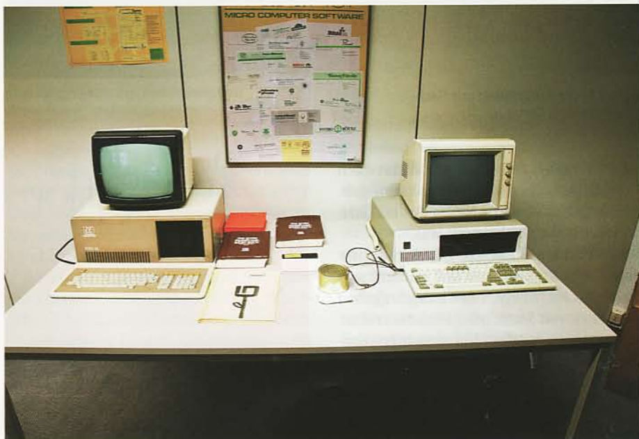
Mit diesen Geräten wurde der Einstieg gemacht: links Alphatronic P3, die erste an Kunden verkaufte Lösung mit dem Betriebssystem CP/M, rechts ein IBM PC, die erste DOS-Maschine.
